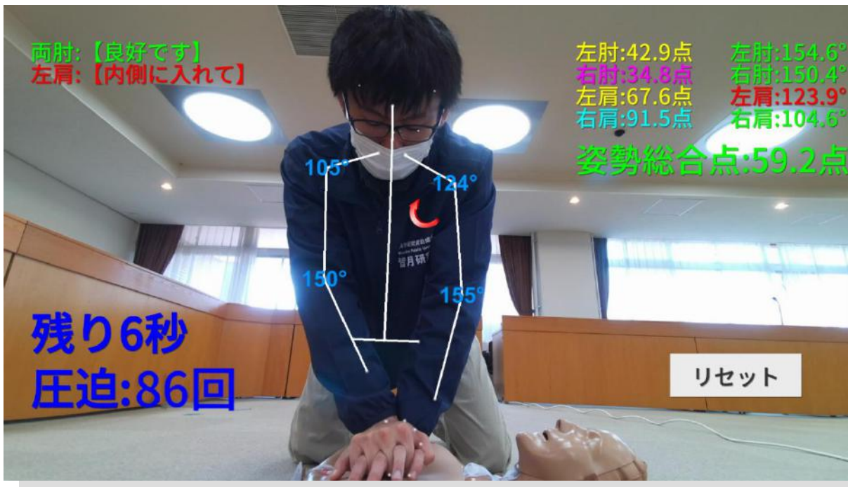
▲Azure Kinectによる正面カメラのインターフェース
